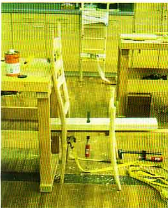
Die Verbindung der vorderen und hinteren Teile des Stuhles erfordert wiederum genaues Anreissen: dazu werden die beiden Teile mit Hilfs-vorrichtungen in die richtige Stellung gebracht und die Bohrlöcher entsprechend markiert
