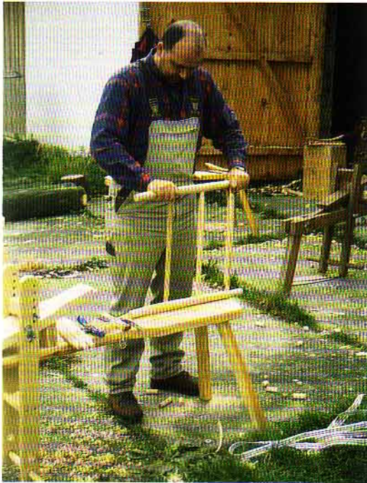
Das Bohren der Zapfenlöcher in den unregelmäßig geformten Beinen der Grünholzstühle erfordert genaues Anreissen und Arbeiten
