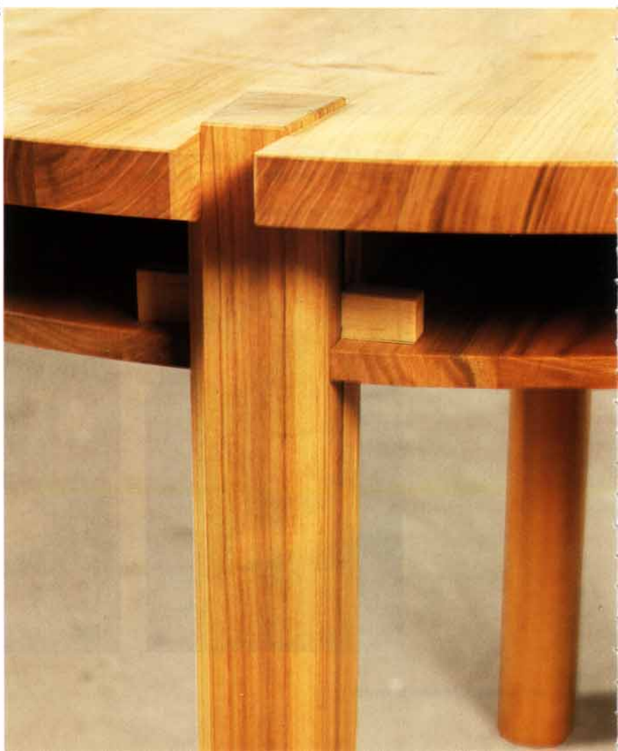
7, 8 Runder Tisch in Kirschbaum mit Zwischenplatte und eingesteckten, verkeilten Beinen.
